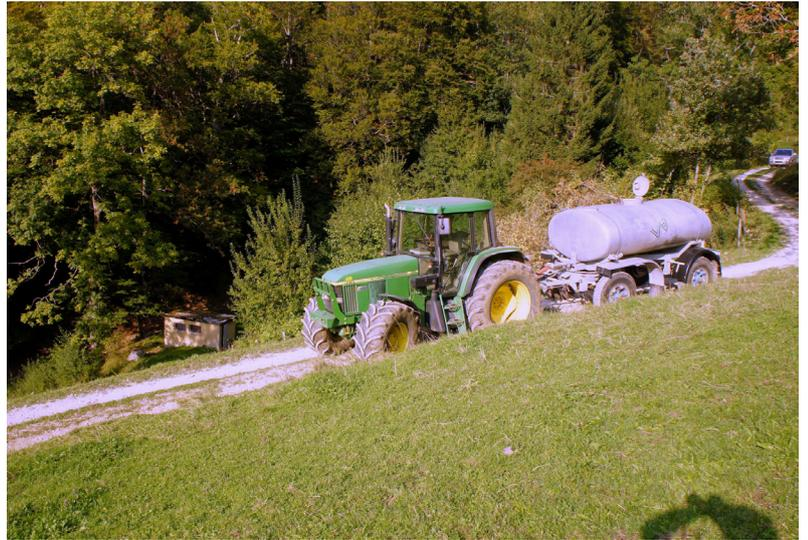
Das Gespann mit dem Zisternenanhänger beim Vorreservoir (links) im Graben zwischen der Ulmet und dem Bogental. Der Zisternenanhänger fasst 6 m<sup>3</sup> Wasser. Der Transport von 36 m<sup>3</sup> dauert 7 Stunden. Diese Menge reicht nur für einige Tage. (Photo: Urs Schneider)
