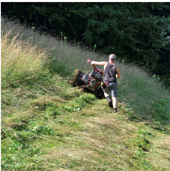
Mähen mit dem Einachs-Motormäher bei 53 % Gefälle.
