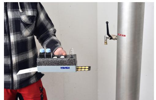
Messung der Chlorkonzentration mit Farbindikator.
